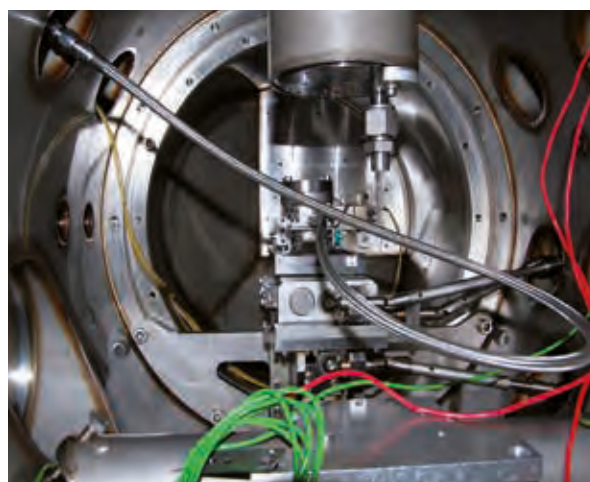
Detail zdroje mikro-hydratovaných molekul v aparatuře CLUB. The source of micro-hydrated molecules in the CLUB apparatus.
