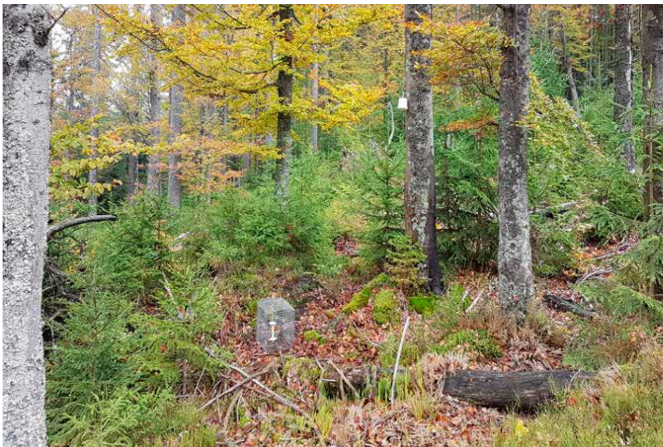
Plocha pro sledování mikroklimatu nedaleko Jelení hory (NP Šumava). Na kmeni je uchycen datalogger pro měření vzdušné teploty ve dvou metrech, v ochranné kleci proti poškození zvěří je umístěn datalogger pro měření přízemní a podzemní teploty a půdní vlhkosti. Autor: Josef Brůna, Botanický ústav AV ČR.
