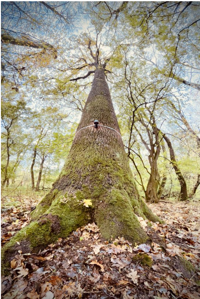
Obr. 1 Automatický dendrometr instalovaný na nádherném více než 200 let starém dubu v lužním lese na rakousko-slovenských hranicích poblíž řeky Moravy, navržený k monitorování vitality stromu
