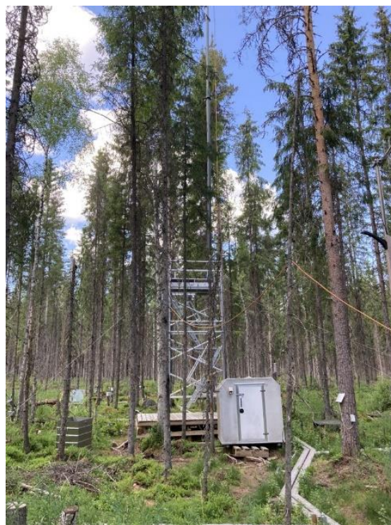
Lesy rostoucí na bažinatých půdách jsou častým zdrojem emisí skleníkových plynů – metanu a oxidů dusíku. Jejich monitoring nad porostem je důležitý k tomu, abychom pochopili, co dělají mikroorganismy pod povrchem (měřicí věž, Ränskälänkorp, Finsko).
